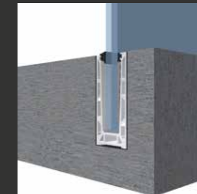
Zócalo en U embebido en el forjado
